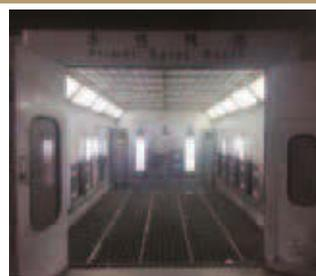
將烤漆房由油性漆改為水性漆，原有柴油加熱改為電加熱，由原廢氣直排放改為VOUc排放，有效的控制了由於噴漆廢氣排放污染空氣。
